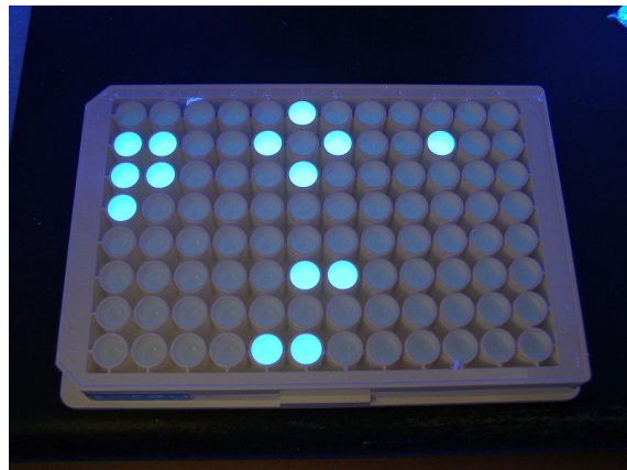
Proben werden mit dem „MPN-Verfahren“ ausgewertet. Die leuchtenden Töpfchen geben Aufschluss darüber, wie viele Bakterien im Wasser vorhanden sind. © Bayerisches Landesamt für Umwelt
