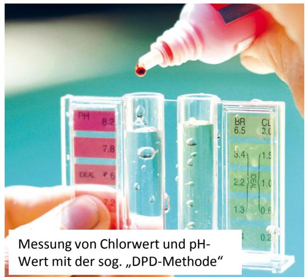
Messung von Chlorwert und pH-Wert mit der sog. „DPD-Methode“
